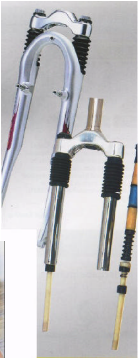
ausgeklügelte Kombination von Stahlfeder und Elastomeren erreicht ein progressives Federverhalten und zusätzliche Dämpfung. Zugstufen-ähnliche Wirkung erzielt der aufwendige Anschlagdämpfer (Elastomer plus Stahlfeder).
